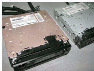
Шасси мультимедийного источника было омеднено, чтобы соответствовал...
