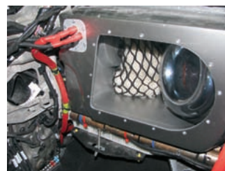
Немного ясности в устройство фронтального сабвуфера
