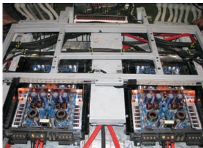
Стальная рама, принявшая вес тыловой части инсталляции
