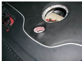
Акустика центрального канала работает на весь «подторпедный» объём
