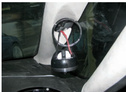
Здесь видно, что пищалка не утоплена в стойку, а как бы прислонилась к ней
