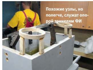
Опора головки — стальное кольцо с приваренными стойками
