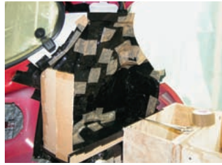
Боксы тыловой акустики: задняя часть оболочки выклеена по машине, передняя — по каркасу с опорными кольцами. Отдельные стеклопластиковые панели закрывают зазоры между тыловой акустикой и отсеком усилителей
