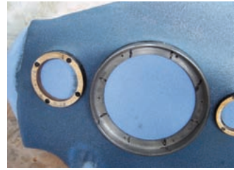
Боксы тыловой акустики: задняя часть оболочки выклеена по машине, передняя — по каркасу с опорными кольцами. Отдельные стеклопластиковые панели закрывают зазоры между тыловой акустикой и отсеком усилителей
