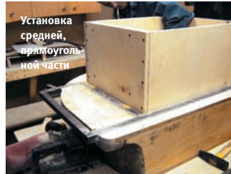
Результат — трёхслойный материал фанера-стеклопластик-фанера
