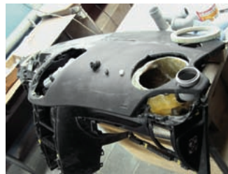
Создание приборно-акустической панели: первый макет, опыты с ФИ, выклейка боксов, установка опорных колец динамиков и алюминиевый отсек головных устройств
