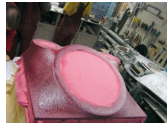
Выклейка рельефной верхней стенки
