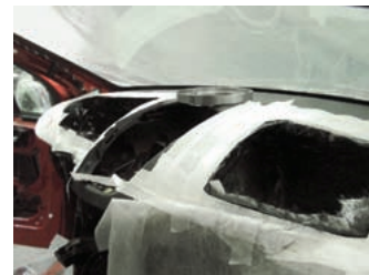
Создание приборно-акустической панели: первый макет, опыты с ФИ, выклейка боксов, установка опорных колец динамиков и алюминиевый отсек головных устройств
