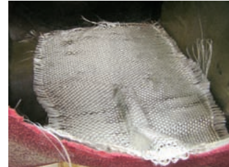
Формирование рёбер жёсткости внутри корпуса
