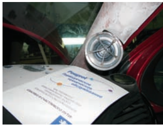
У пищалок RS корпуса свои, а опорой им служат стальные кольца на стойках
