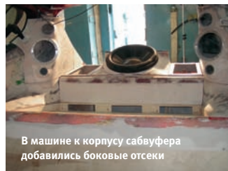
Они служат для размещения двух аккумуляторов по 100 А ч
