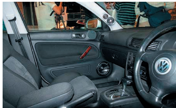
В салоне Пассата твитеры и среднечастотники установлены в передних стойках, низкочастотные динамики расположены в нижней части передних дверей, а сабвуфер занял место спинки заднего дивана. Подиумы над дверными ручками в данной конфигурации закрыты заглушками
