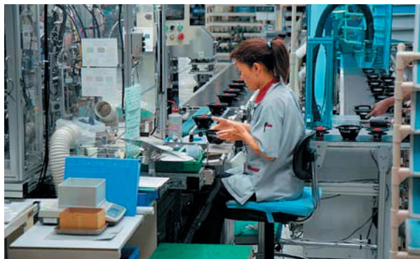
Ежегодно компания Tohoku Pioneer выпускает до 100 миллионов разнокалиберных динамиков, но производительность предприятия в Тэндо — всего 15 тысяч штук в год. На сборочной линии повсеместно используется ручной труд, зато каждый динамик подвергается короткой «звуковой» проверке в маленькой изолированной комнате, сквозь которую проходит конвейер
